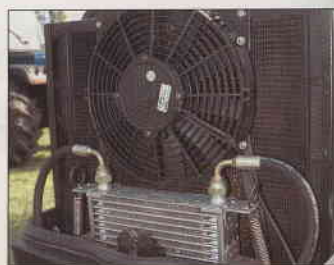
Il sistema di autopulizia dei radiatori e delle griglie prevede una ventola soffiante ad azionamento elettrico che lavora in alternativa alla ventola tradizionale.
