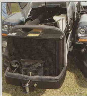
Il radiatore è stato aumentato di dimensione per migliorare il raffreddamento. Davanti è visibile lo scambiatore di calore dell'olio idraulico.
