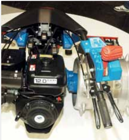
Dettaglio del motore, un Subaru da 12 cavalli, e, in arancione, del pomolo che comanda avanzamenti
