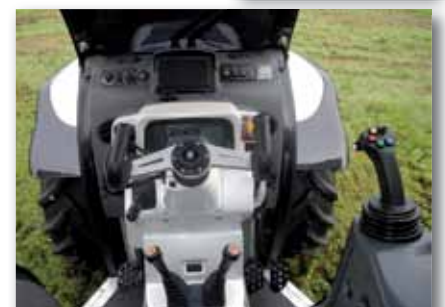
Sopra, il sistema "DualSteer". A lato, l'inversore elettroidraulico. Sotto, il posto guida, visibile sopra al cruscotto il display della telecamera posteriore
