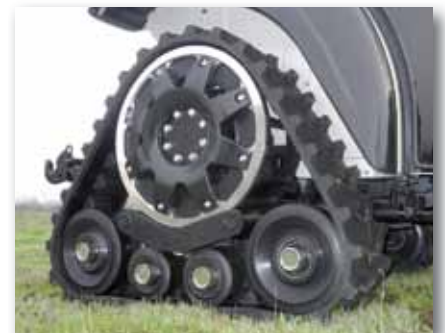
L'inserimento dei semicingoli posteriori ha imposto la revisione dei relativi gruppi di riduzione finali
